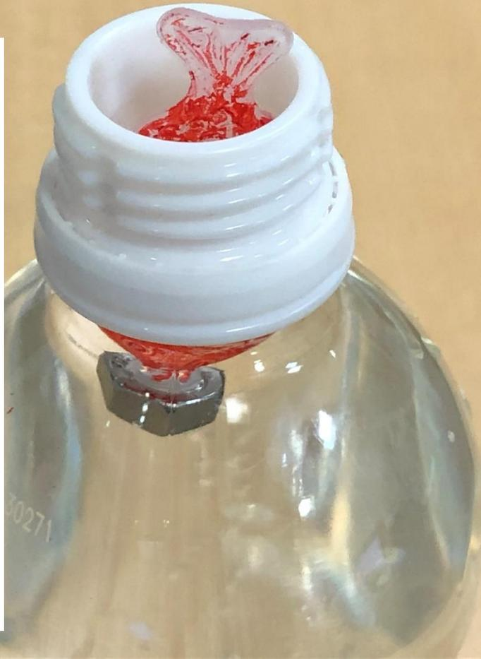
**ペットボトルを強く握ったり離したりすると、浮沈子が浮いたり沈んだりします。**
